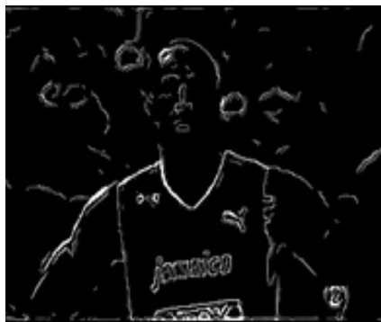
Figure 3 Edge detection using Canny edge detector
